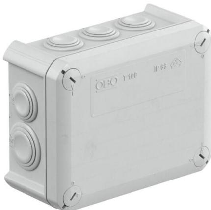
Kaabliharukarp kaablite ja juhtmete ühendamiseks nii sise- kui ka kaitstud välis-tingimustes. Ristkülikukujuline, läbistatavate tihenditega külgedel ja väljalödavate sisenditega põhjas. Sobib seina- ja laepaigalduseks ning paigaldamiseks montaažiplaadile. Võimalik sisekinnitus ja montaaž läbi nurgapüstakute. Kiirkinnitusega kaas, plommitav. Valmistatud halogeenivabade ja UV-kindlastest materjalidest.
