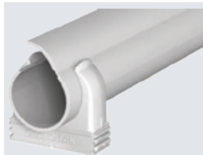
Komplekt koosneb elektripaigaldustorudest Quick-Pipe® ja pinnale paigaldatavatest Quick-klambritest. Kaablite ja juhtmete pindpaigalduseks siseruumidesse ning kaitstud väliskeskkonda. Universaalne kinnitus seinale ja lakke. Sõltuvalt läbimõõdust sisaldab komplekt kuni 50 m toru, igaüks 2 meetrit pikk ja kuni 156 Quick-klambrit. Paigaldatav temperatuurivahemikus -25° kuni 60 °C.
