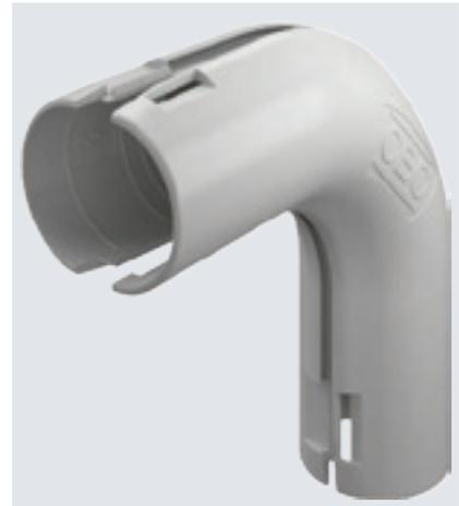
Lisadetail plastist elektriinstallatsioonitorude 90° poognate loomiseks. Sobib Quick-Pipe®-i või gofreeritud torudele. Tööriista abita sulgemine ja avamine. Paigaldatav temperatuurivahemikus -25° kuni 60 °C.
