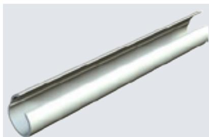
Avatud plasttoru Quick-Pipe® kaablite ja juhtmete pindpaigalduseks nii sise- kui ka kaitsstud välisingimustes. Paigaldus seinale ja lakke Quick-klambri, proQuick-klambri ning Multi-Quick-klambri. Tööriistavaba sulgemine ja avamine klambris keeramise teel. Paigaldatav temperatuurivahemikus -25° kuni 60 °C.
