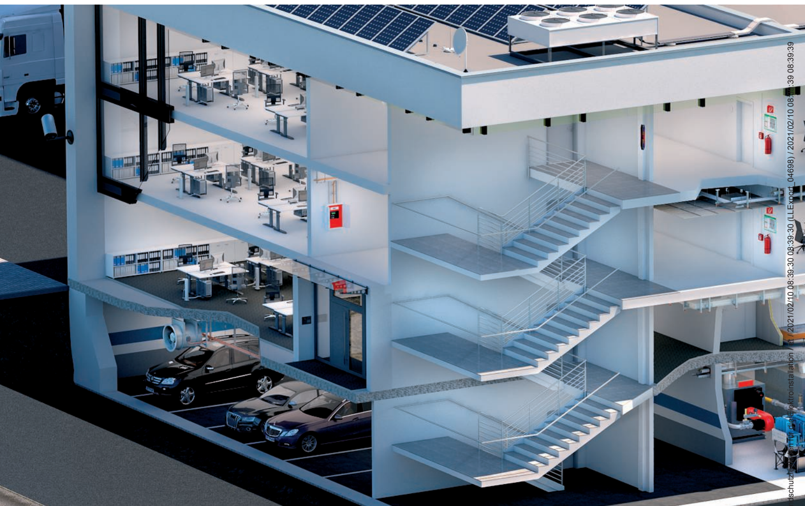
Tuletõkkeseksioonide moodustamine tuletõkkeseinte või tulekindlate komponentide abil
