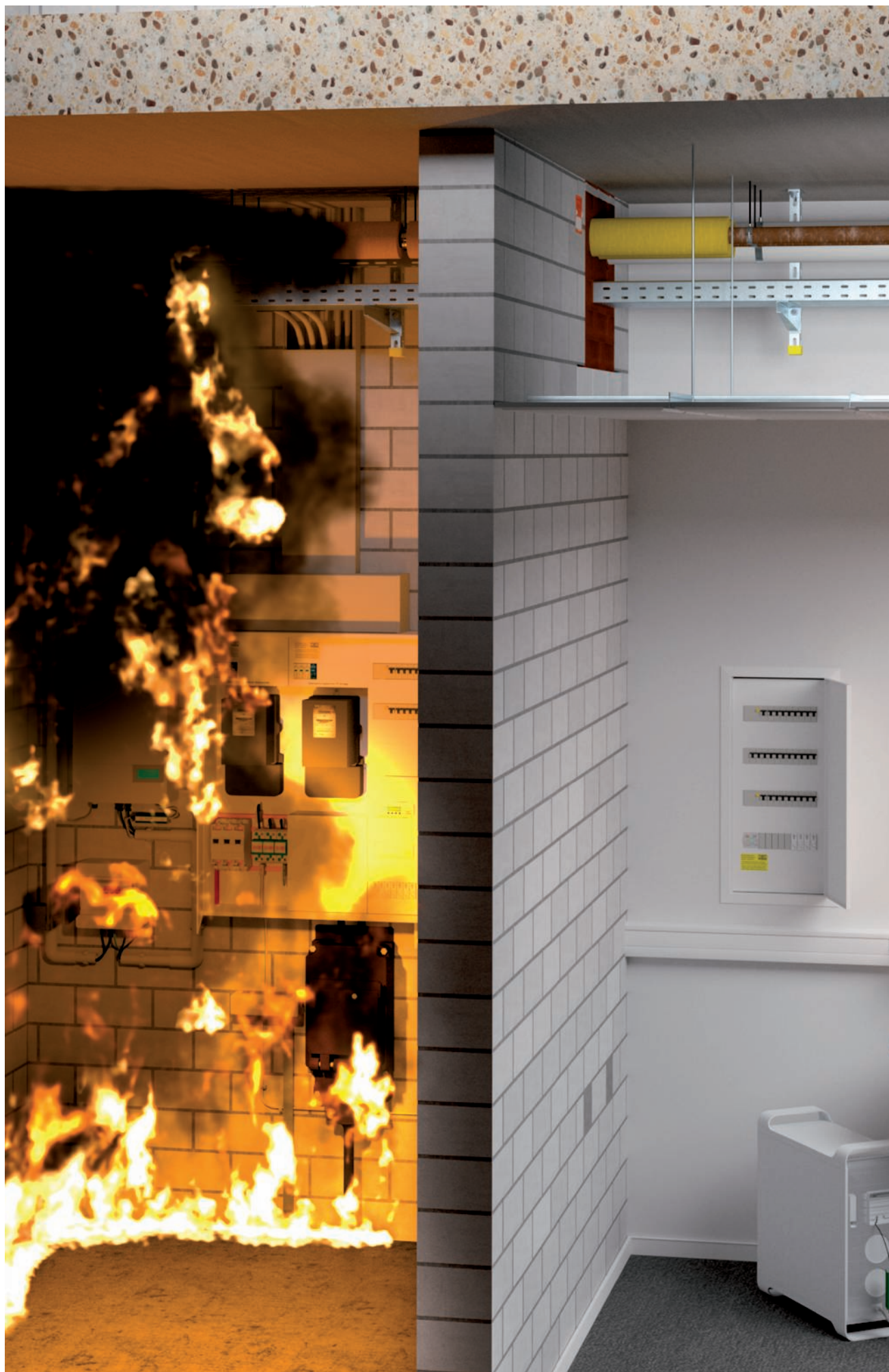
Lae- ja seinaläbiviike saab tule ja suitsu eest tõhusalt tihendada
