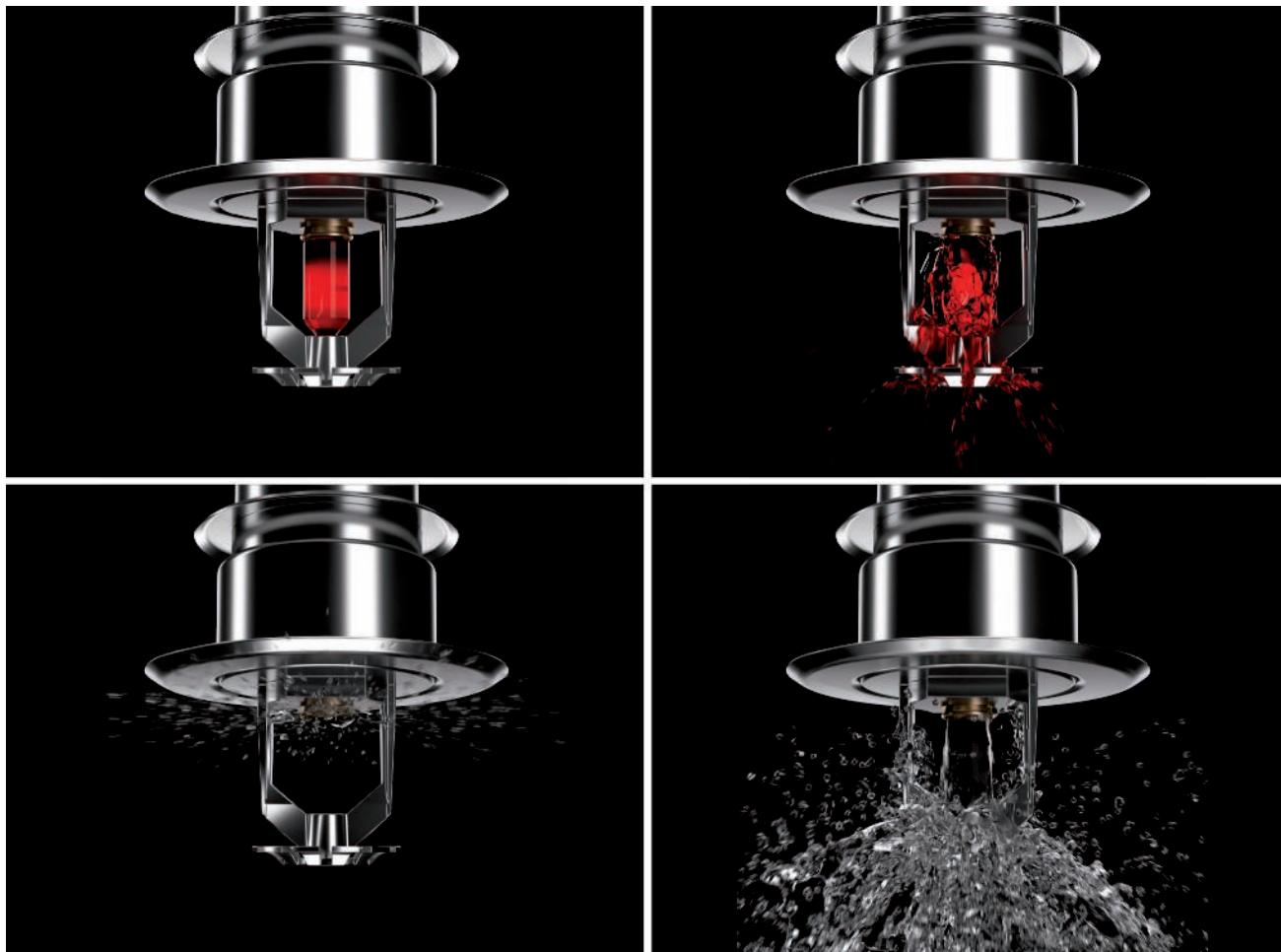
Sprinkleripea rakendumine 68 °C nimitemperatuuri ületamisel klaasanumas
