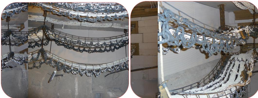
Испытательные объекты в испытательной печи компании FIRES, s.r.o., после испытания на огнестойкость
