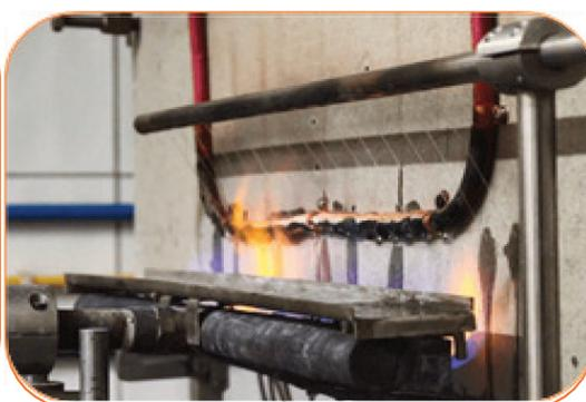
Тестирование сохранения изоляционных свойств кабеля
