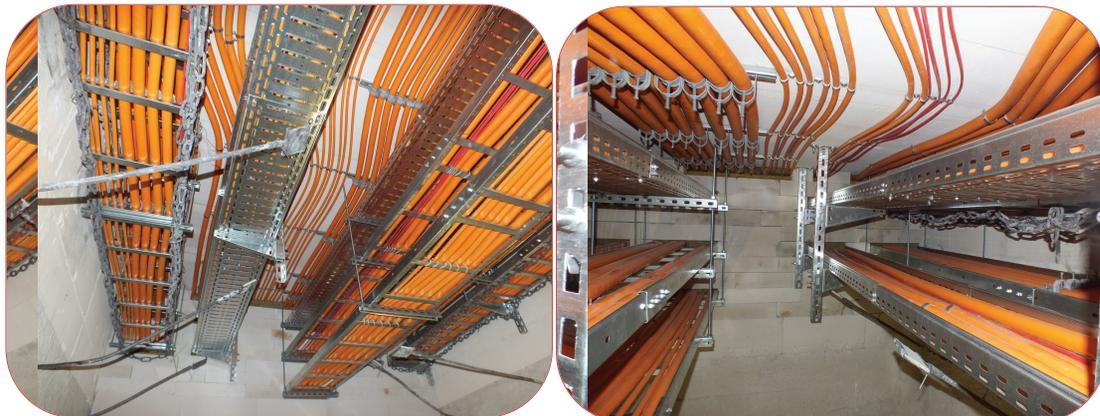
Испытательные объекты в испытательной печи компании FIRES, s.r.o., перед испытанием на огнестойкость
