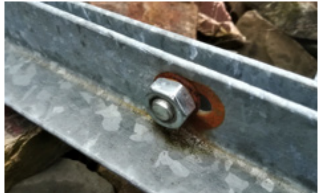
Tsingitud seib ja roostevabast terasest mutter andsid tulemuseks ebasoodsa pinnasuhte (allikas: OBO Bettermann)
